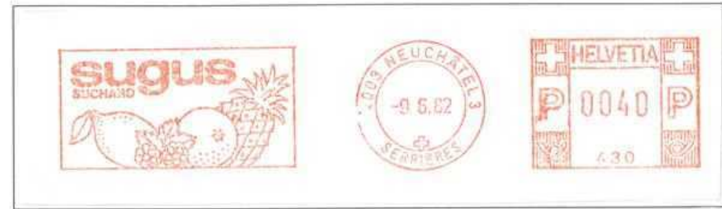
Frankeermachinestempel Hasler Mailmaster, waarde type 0000 afm. 32x25mm, afstand tussen datumstempel en waarde 9mm, centerafstand datum en waarde 37mm
