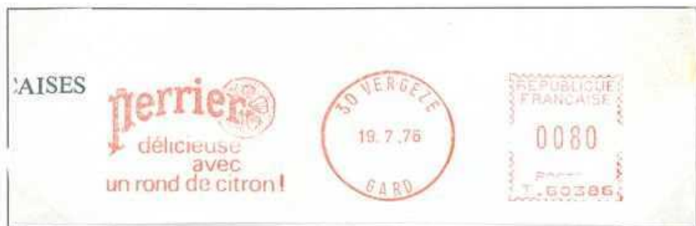
Frankeermachinestempel type Havas T met waarde type 0000 + prefix "T" + Datum 11 x 2 mm en punten tussen datacijfers.
